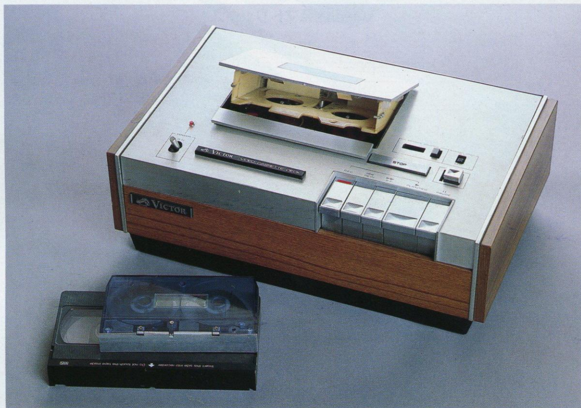
昭和47年に試作したVHS第1次試作機。サイズはA4判と小型だったが、ドラム径は74.5mmだった。テープは1時間で、チューナーはなかった
