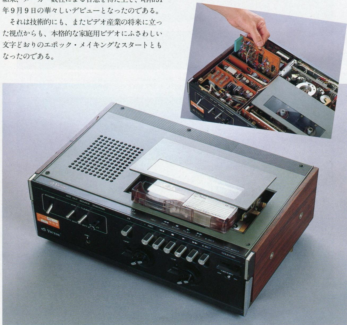
HR-3300完成前の第4次試作機。ドラム径は62mm、テープカセットもほぼVHSと同じものに仕上げていた
