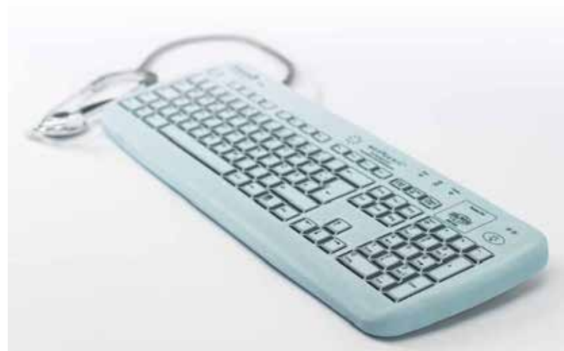
除菌清掃に最適なデザインを採用した感染症対策用防水型キーボード
