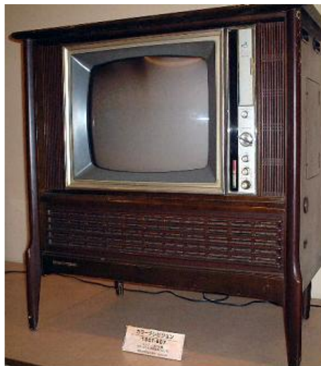
昭和42年 19CT-807 名器 RF-AFC付シーンコントロール ハイファイクロマ回路 久里浜 高柳記念館
