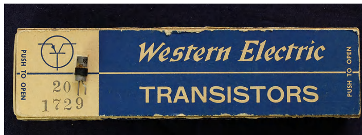
Bel Lab のトランジスター発明後、その親会社の Western Electric から最初に発売された A1729 (シンボルの右下)
